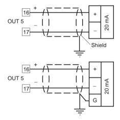
Fig. 16.A OUTPUT 5 WIRING
