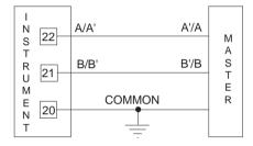
Fig. 17 - RS-485 WIRING
