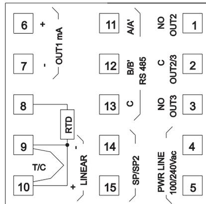
Fig. 3 .A REAR TERMINAL BLOCK
