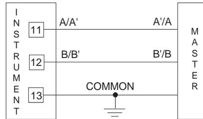
Fig. 11 - RS-485 WIRING
